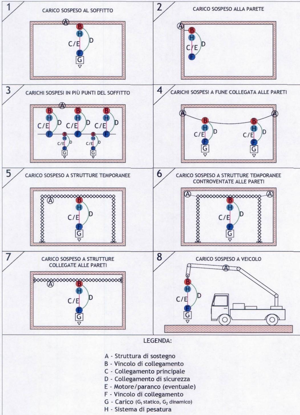
Fig. 1 – Schemi ricorrenti di tipologie di carichi sospesi
